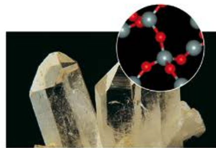
El quars és una estructura formada per àtoms d'oxigen i silici [en proporció 2 : 1] que s'uneixen amb enllaços covalents
